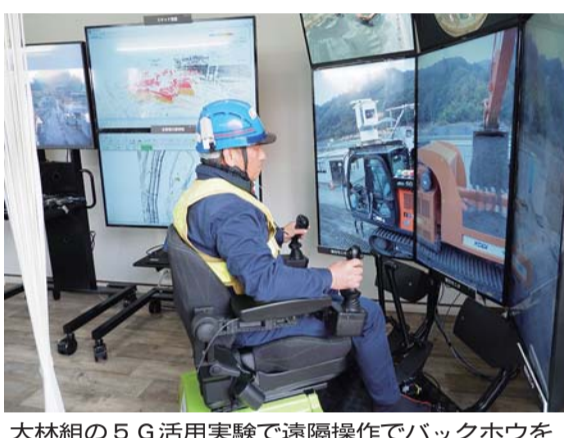
大林組の5G活用実験で遠隔操作でバックホウを操縦するオペレーター
