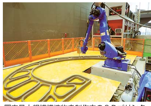
国内最大規模構造物を制作中の3Dプリンター
