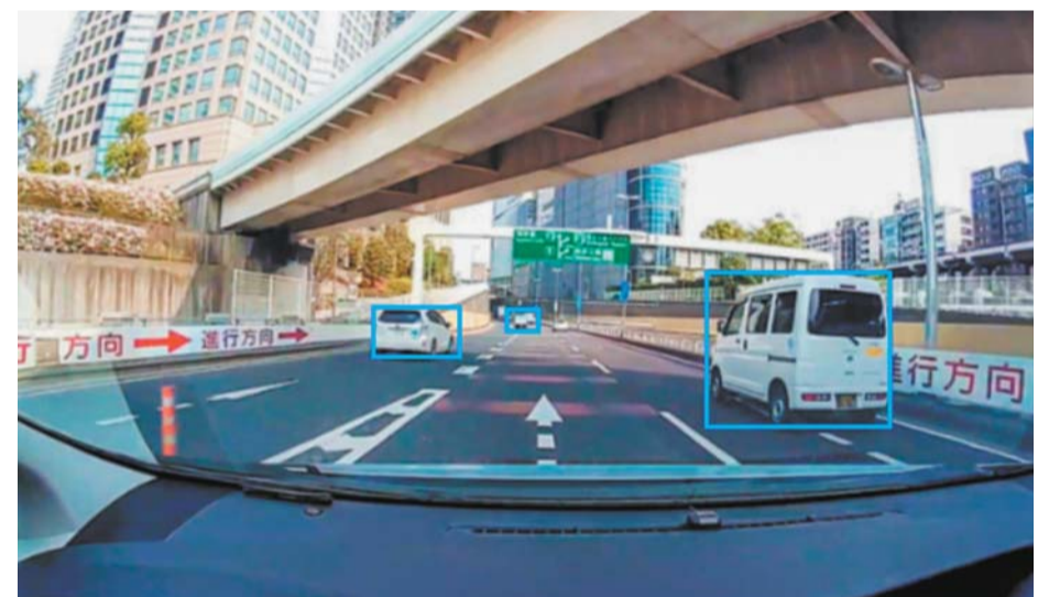
ドライブレコーダのカメラ映像から車両等の物体を自動認識
