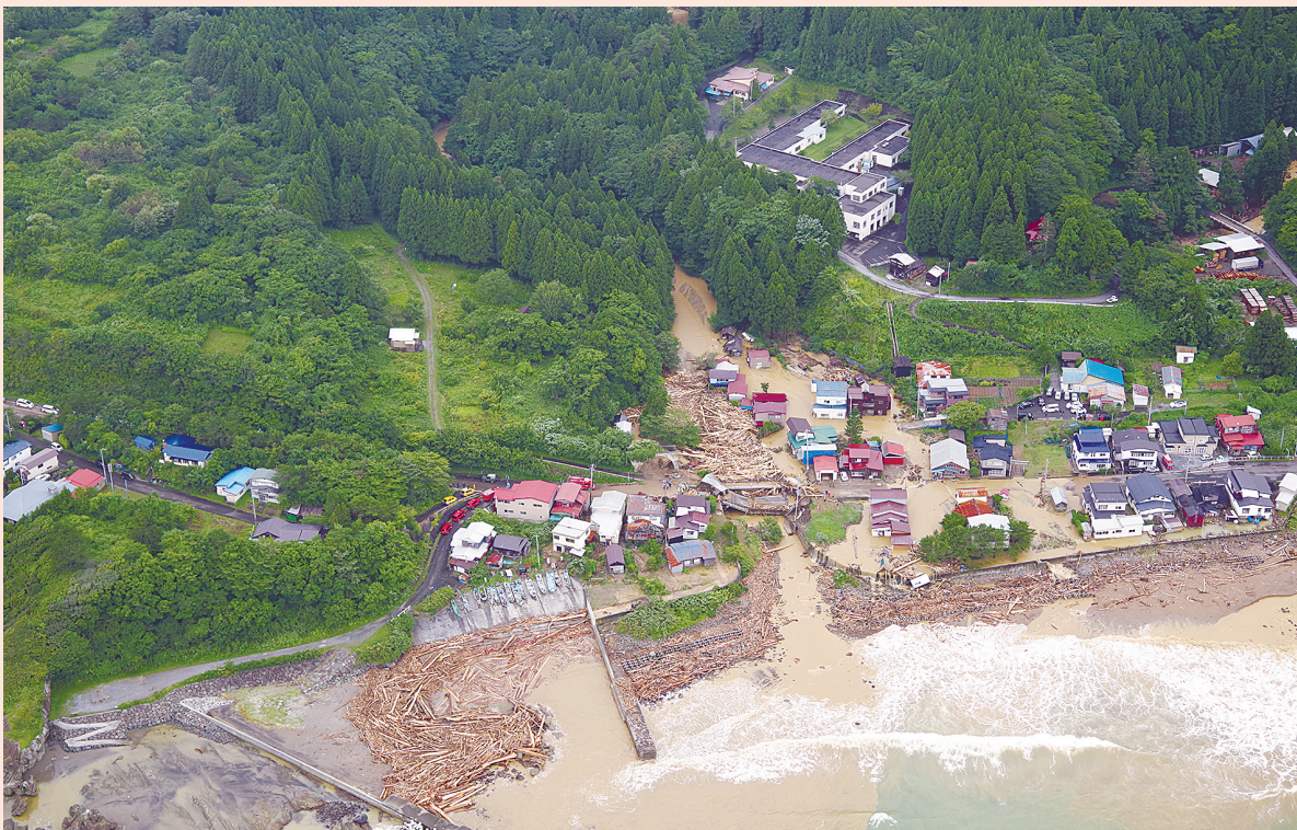
2021年8月10日から青森県内で降り続いた大雨によって、下北地域を中心に多くの被害が発生した。大赤川と小赤川の両方から泥水が流下し、特に小赤川から大量の流木が流出した。また、国道279号の小赤川橋が落橋したほか、橋には流木が多数捕捉されている。さらに、土砂が周辺人家まで到達している様子が確認できる(青森県むつ市)
